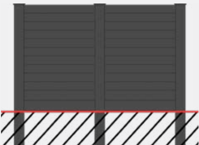
Clôture avec poteaux scellés
