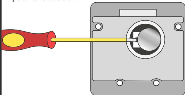
6- Replacer la nouvelle pile en l'inclinant de droite à gauche et en appuyant légèrement.
