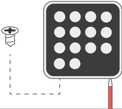
2- À l'aide d'un tournevis plat, faites levier dans l'encoche en dessous du digicode.
