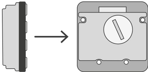
4- Dévisser le cache de la pile à l'aide d'une pièce ou d'un objet plat.
